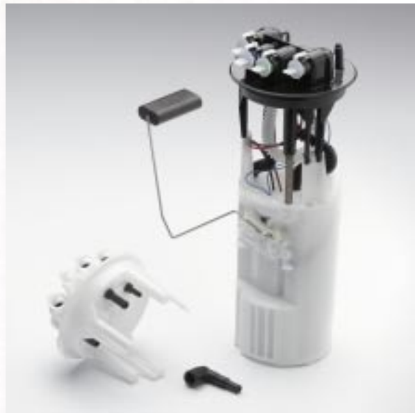
Module de jauge / pompe Ce module apporte le carburant au moteur et détecte le niveau de remplissage du réservoir. Cela implique un contact permanent du matériau avec du carburant à haute température. Or, à haute température, l'Hostaform possède une excellente résistance au carburant et une excellente stabilité dimensionnelle.
