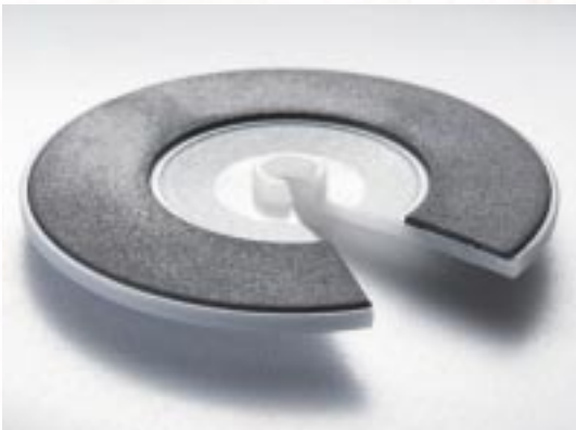
Plateau de positionnement pour lecteur de CD de voiture Ce plateau de positionnement pour lecteur de CD de voiture est fabriqué en moulage par injection à deux composants, ce qui réduit les coûts de fabrication. L'Hostaform – en combinaison avec des élastomères spécialement étudiés – a une bonne adhérence.
